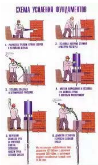
Одна из технологий укрепления фундаментов
