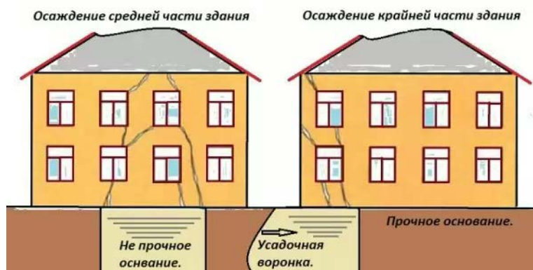
Влияние просадки фундамента на конструкции строения
